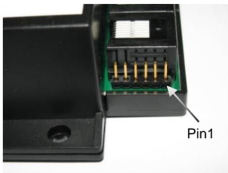
Die Masse für die Schaltkontakte, die mit dem S88-Modul verbunden sind, wird entweder der Zentrale bzw. dem Gleis (bei 3-Leiter-Anlagen) entnommen oder kann dem S88 Modul an der Stiftleiste (Pin 2, s.o.) abgegriffen werden.
